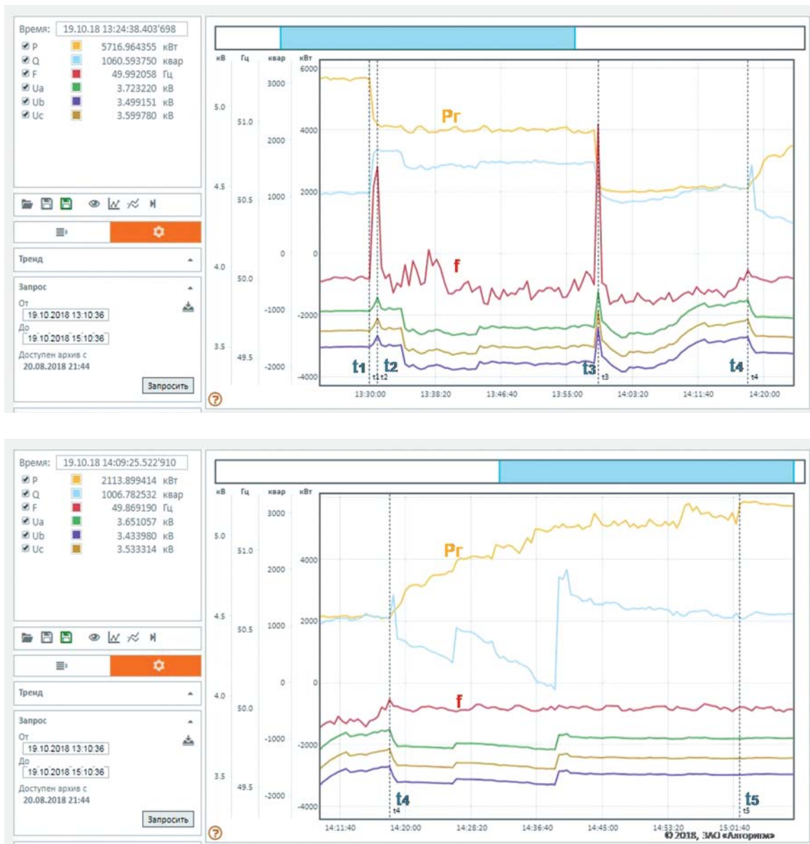
Рис. 9. График изменения f , P_r , Q_r , U_a , U_b , U_c (значения на 10 периодах частоты, период записи в архив – 30 с)
