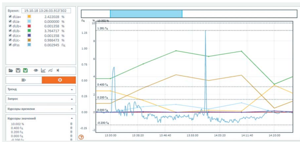
Рис. 10. График изменения ПКЭ: \Delta f (10 с), \pm\delta U_A , \pm\delta U_B , \pm\delta U_C (10 мин.)
