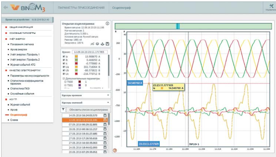
Рис. 4. Ввод 0,4 кВ. Осциллограмма фазных токов и напряжений (период измерений мгновенных значений – 31,25 мкс)
