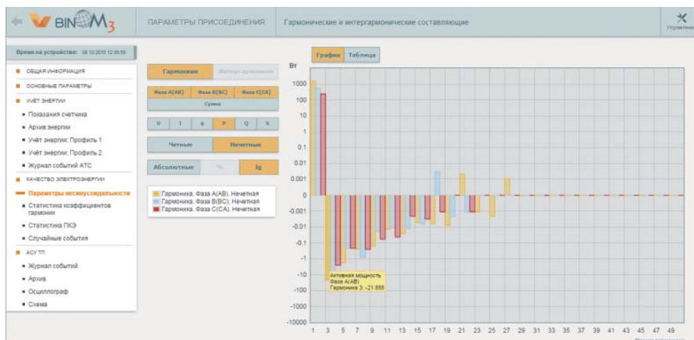
Рис. 2. WEB-сервер BINOM337U3.220I3.5S16T2: гистограмма активной мощности гармоник (среднеквадратические значения, нечетный порядок, логарифмическая шкала)
